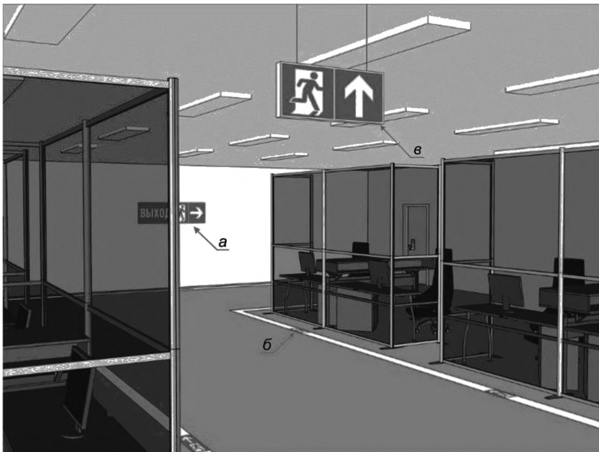
а — настенный комбинированный указатель направления эвакуации; б — напольная направляющая линия с включенным в ее состав указателем направления эвакуации; в — подвесной комбинированный указатель направления эвакуации
